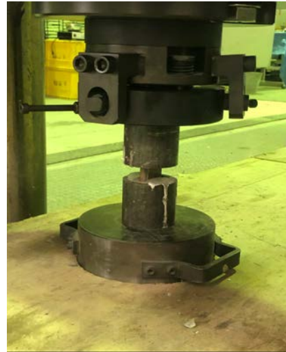
図-7 圧縮試験のセットアップの様子
