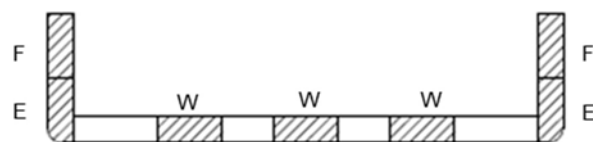
図-3 クーボン切り出し位置 (1方向材)
