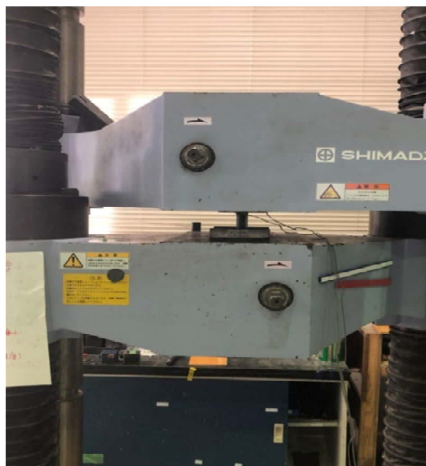
図-2 引張試験のセットアップの様子
