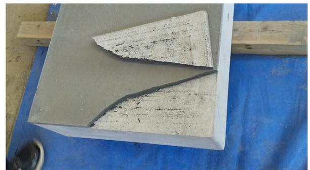
図-4 上面増厚層の水平せん断による剥がれ状況
