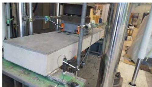
図-2 曲げ載荷実験の状況
