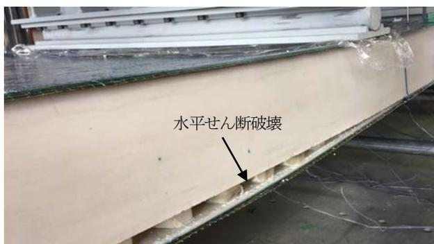
図-6 破壊状況（曲げ載荷実験）
