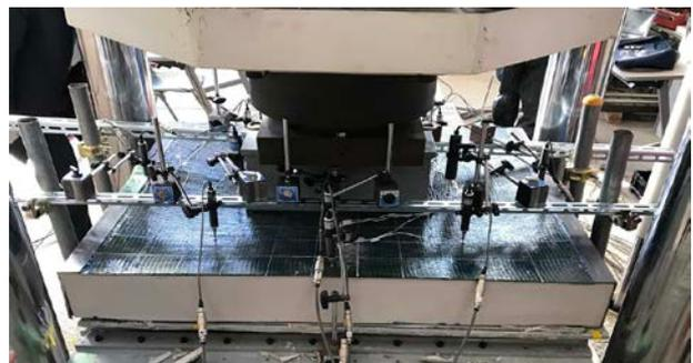
図-8 押抜きせん断載荷実験状況
