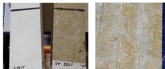
写真-1 フランジ部供試体 (左：屋外暴露，右：促進劣化20,000時間)
