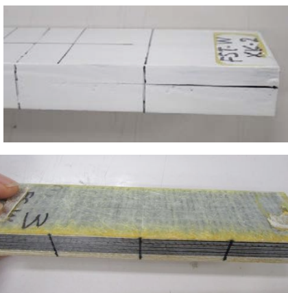
写真-4 層間せん断試験後のフランジ部の供試体 (上：塗装有，下：塗装無)
