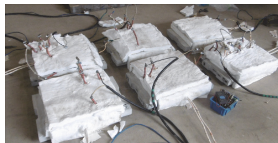
図-3 断熱材の設置状況
