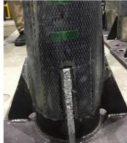
図-5 引張側CFRP剥離
