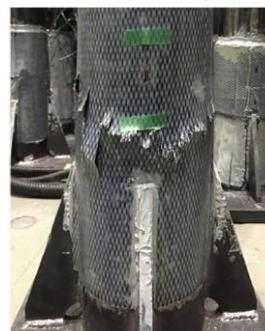
図-10 圧縮側破壊 (一軸)
