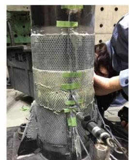
図-11 圧縮側破壊 (二軸)
