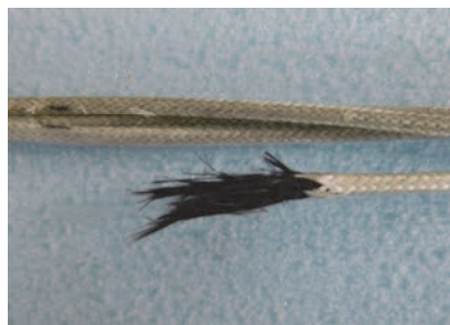
a) ほうき状の素線の破断 (No.1)
