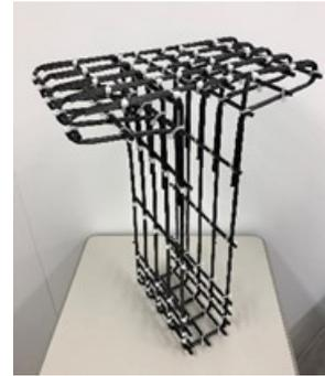
図-23 CFRP ワイヤーによる T 桁の配筋 (1/2 モデル)
