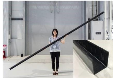
図-17 連続プレス成形による長尺部材の成形 (L=4m)
