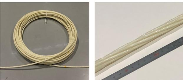
図-21 GF/PP 超高速引抜き成形による FRP ワイヤー
