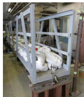
図-21 活荷重載荷試験の状況
