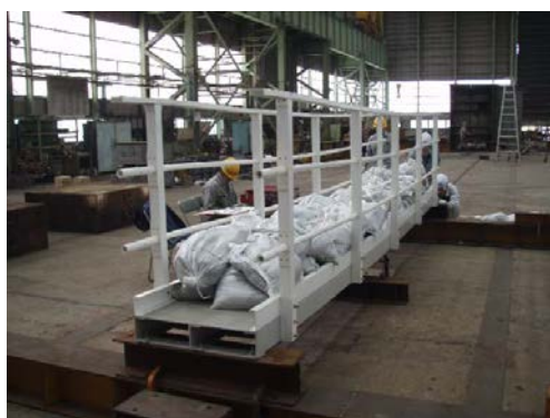
図-16 活荷重載荷試験の状況
