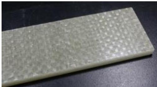
図-2 ハンドレイアップ成型された GFRP 板
