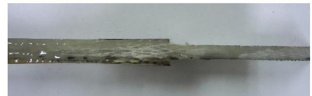
(f) D200-DD (母材繊維破断)
