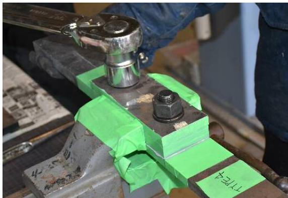
写真-3 ボルト締め付けの状況
