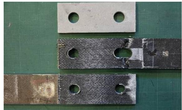
写真-5 HFRP板の接合面の表層はく離破壊 (TYPE4)
