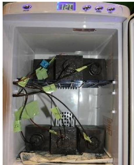
写真-7 チャンバーによる温度管理の状況
