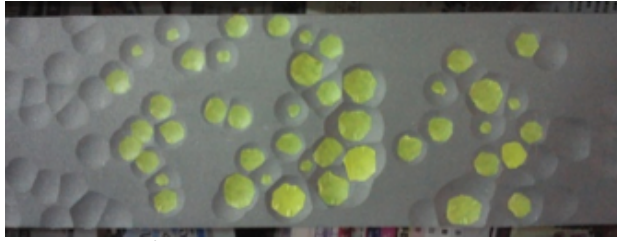
図-12 紙テープによる残存錆の再現（P3-3供試体表面）
