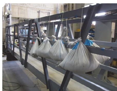
図-16 上段手摺りへの砂のうの載荷状況（10M6PR）
