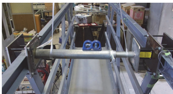
図-18 上段手摺りの水平方向載荷試験のセットアップ
