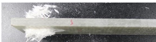
図-6 支圧破壊による面外変形(ボルト軸力無 : J10)
