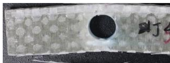
図-13 引張破壊の様子
