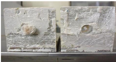
(b) HP リベットが抜けた試験体
