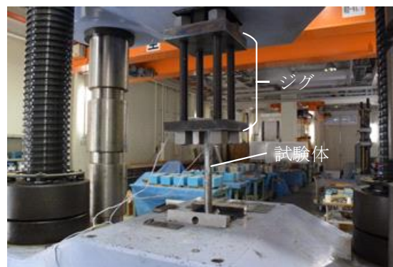
図-5 使用した鋼製の治具
