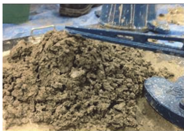
図-4 スランプ試験後の外観 ( V_f=0.25\% )
