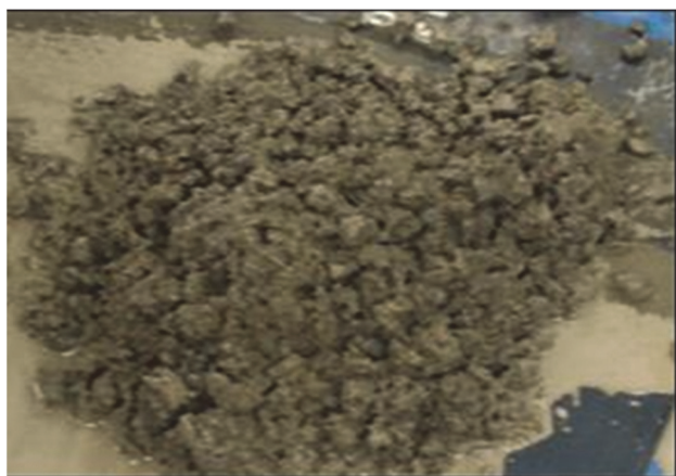
図-3 スランプ試験後の外観 ( V_f=0.05\% )
