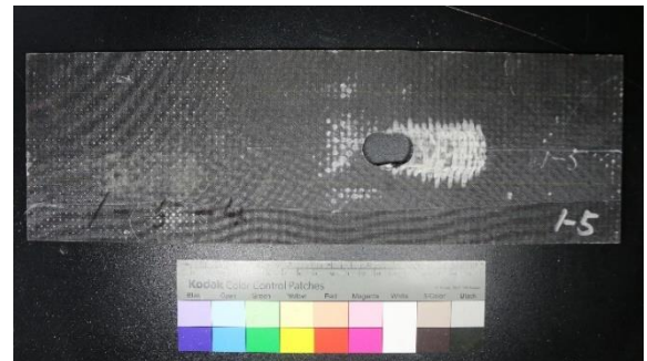
図-7 試験後のボルト軸力を導入した支圧試験体
