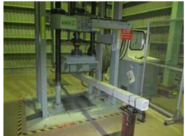
図-11 3点曲げ試験状況
