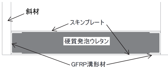
図-2 サンドイッチパネル床版の拡大図
