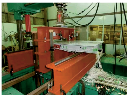
写真－6 支持桁取付部の耐荷力確認試験状況
