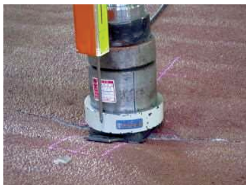
写真-3 リブ間集中荷重載荷試験後の損傷状況
