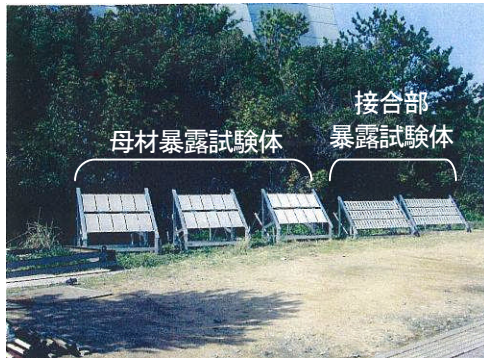
写真-3 暴露試験体の設置状況（当初）
