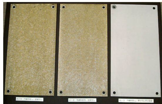
写真-4 暴露8年後の母材試験体の表面状態 (左から、A-1、A-2、A-3試験体)
