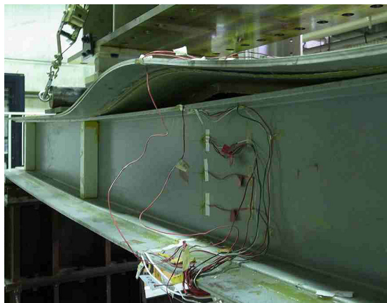
図-10 終局時の試験桁の破壊状況
