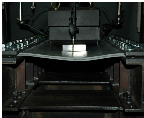
図-17 終局時における試験版の変形状況
