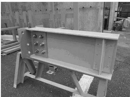
図-21 ブラケット製作完了状況
