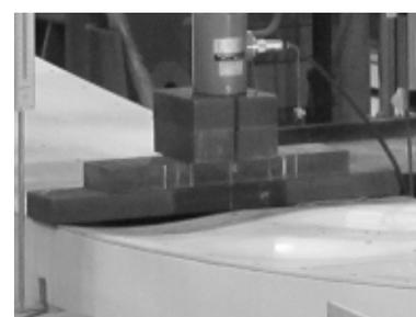
(c) 荷重板直下の変形状況
