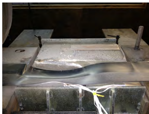
写真-2 試験体破壊状況 (リブあり 5cm)
