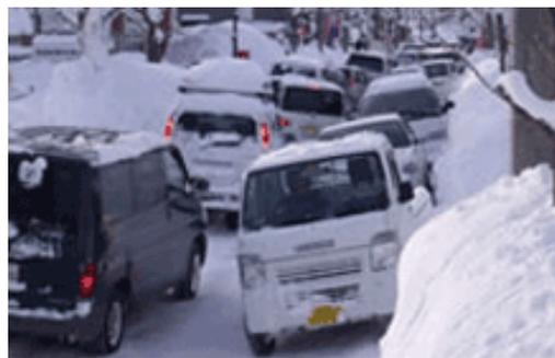
写真-1 積雪による幅員の狭小化の例
