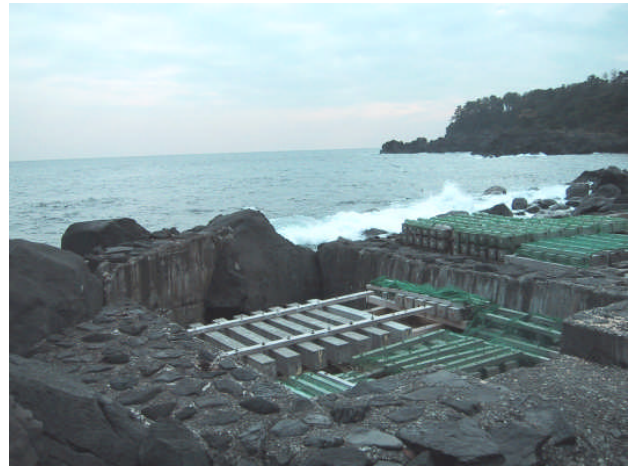
写真-1 飛沫帯の自然暴露
