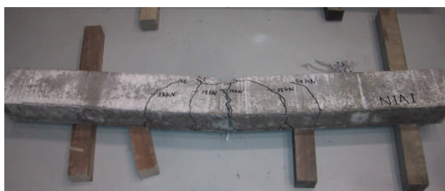
NIAI試験体（飛沫帯自然暴露、アラミド）
