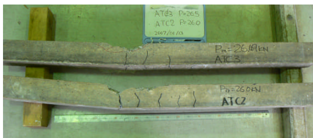
AC2,3試験体（促進暴露、カーボン）
