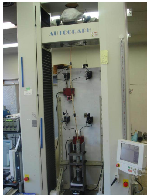
図-3 引張強度試験状況
