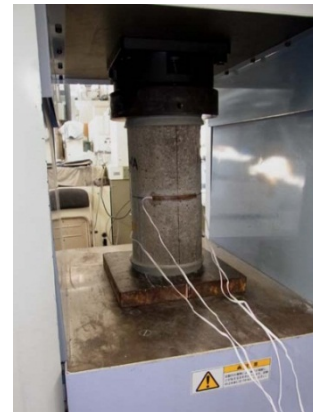
図-3 圧縮試験の実施状況（無補強供試体）
