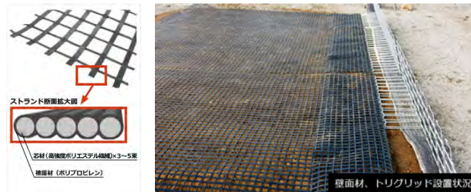
図-3 検討に用いたジオテキスタイルの概要
