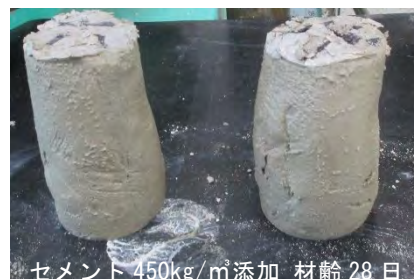
写真-1 硬化不良改良土
