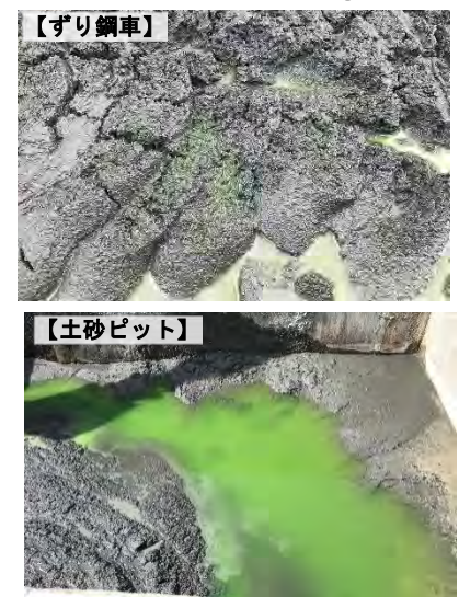
写真-7 実機搭載の摩耗検知装置からの染料排出状況
