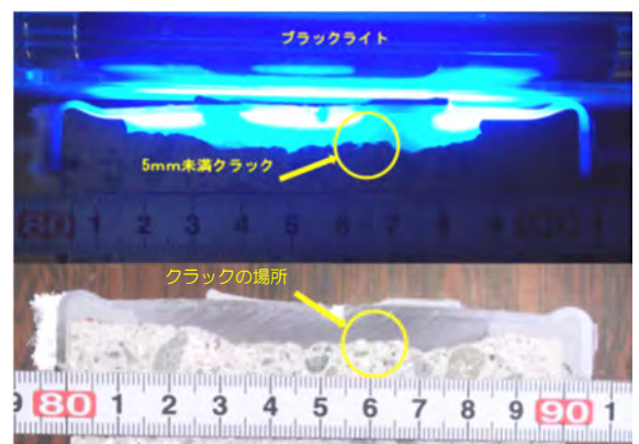
写真-5 マイクロクラック測定状況
