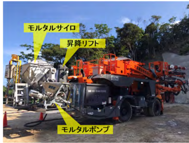
図-4 モルタル供給装置の一体化
