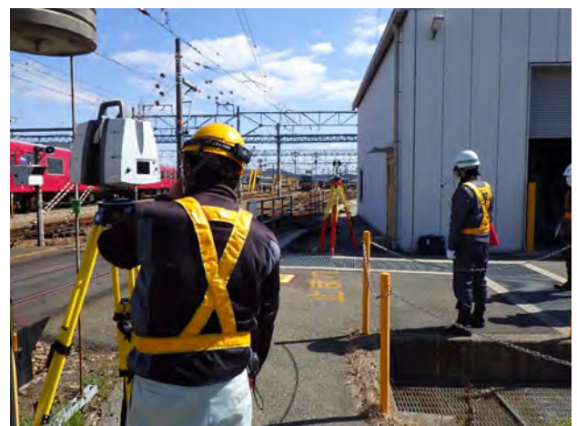
写真-2. 地上レーザースキャナによる測量
