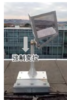
図-10 リフレクターの強制変位
