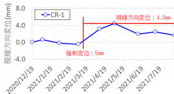
(a)CR-1 (強制変位 5 mm) の視線方向変位
