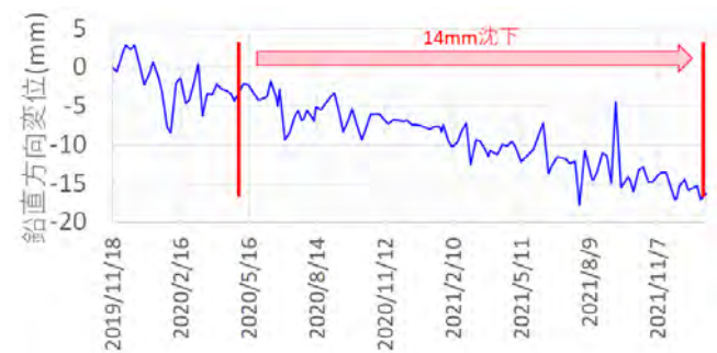
図-17 InSAR による長期計測結果(観測局 GD-2)
