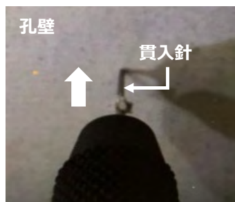
写真- 1 原位置挿入型装置での針貫入時の映像
