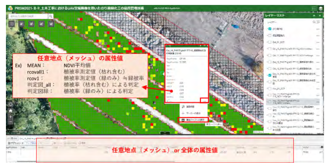
図-11 WebGIS アプリケーション閲覧例① 任意メッシュのデータ参照
