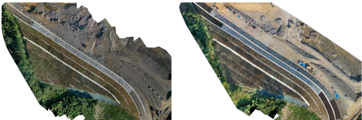
図-6 対象のり面の植生状況（RGB オルソ画像 左：10 月試行時，右：11 月試行時）
