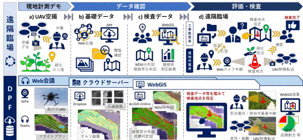
図-1-3 遠隔臨場によるのり面緑化工の検査の試行概要
