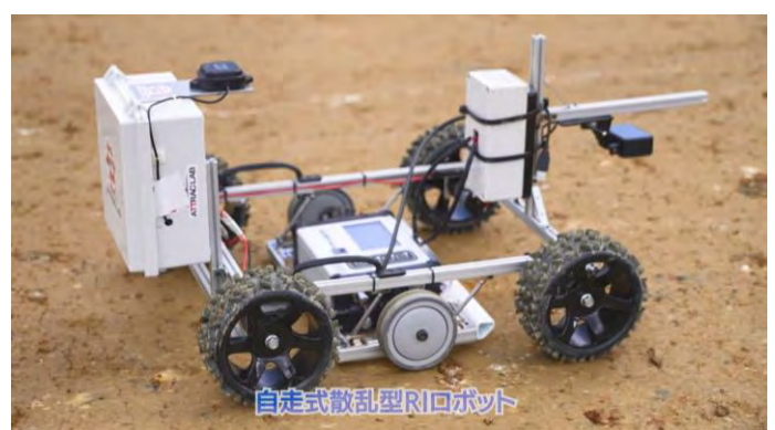
(d) 自走式散乱型 RI ロボットの転圧面走行状況
