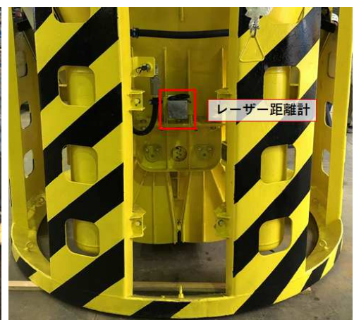
写真-3 レーザー距離計の設置状況
