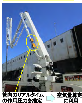
図-13 IoT ポンプ車からの圧送情報の取得状況
