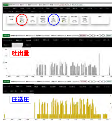
図-13 IoT ポンプ車からの圧送情報の取得状況
