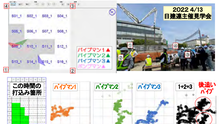
図-11 実施工での作業履歴取得 (塩浜立体での試行)
