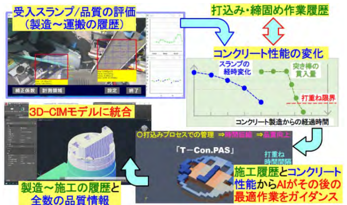
図-5 全数品質情報の施工最適化への反映概念図
