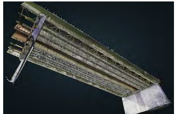
図-18 既設橋梁計測点群データ
