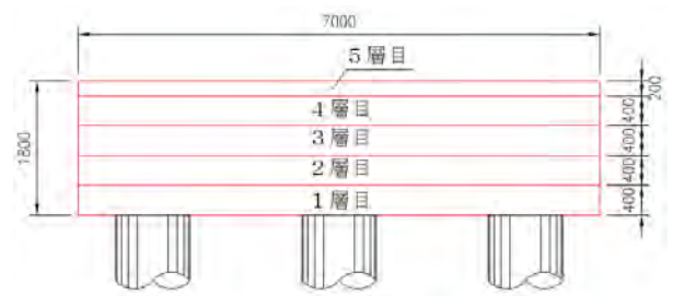
図-9 コンクリート打設箇所
