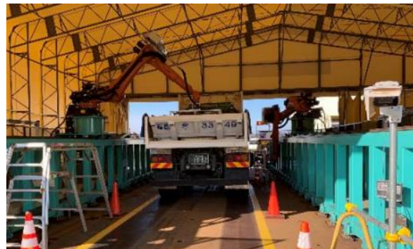
写真-6（左）手動によるスクリーニング作業、（右）ロボットによるスクリーニング
