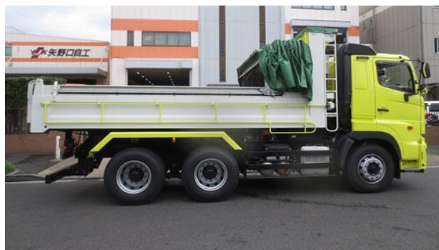
写真-5 自動シート開閉ダンプ
