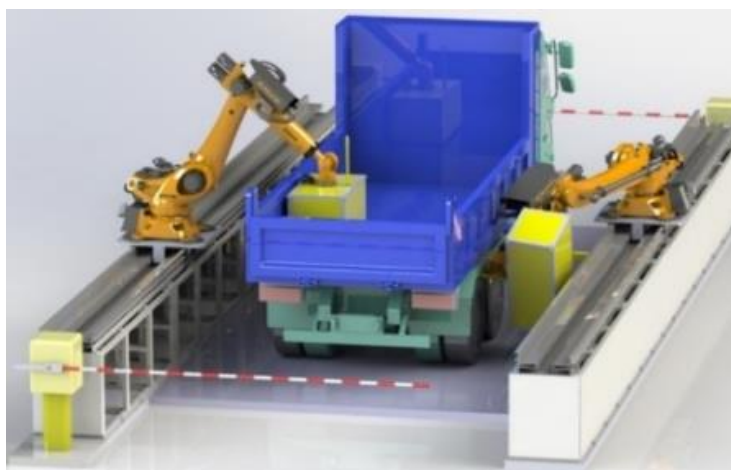
写真-7 ロボットによるスクリーニング イメージ図
