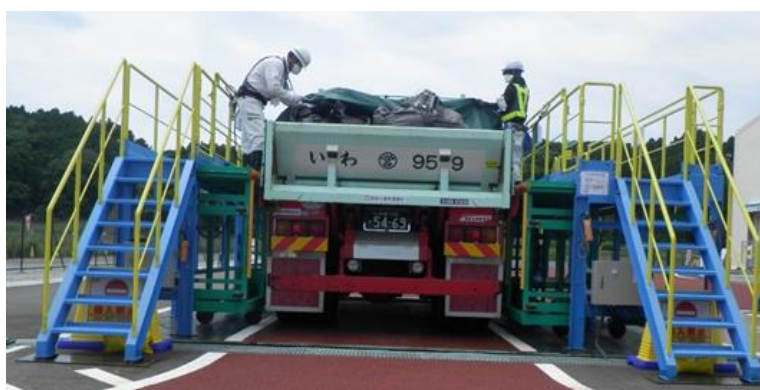
写真-3 (左) 従来の足場上での作業状況、(右) 自動スライド足場上の作業状況
