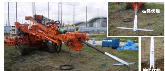
図-1 標準施工機及び攪拌翼
