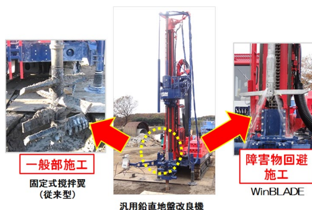
図-9 汎用地盤改良機による施工形態
