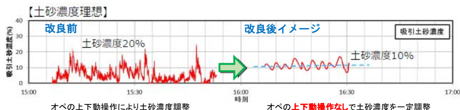
図-11 改良後の土砂濃度管理のイメージ
