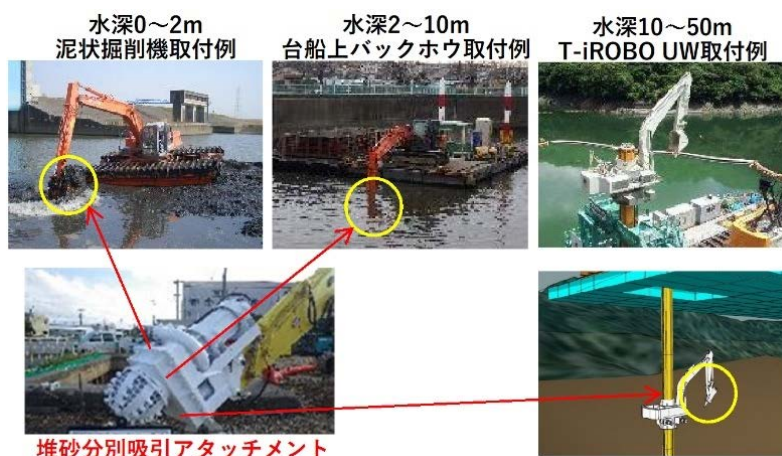
図-17 水深に適応したベース機への装着例
