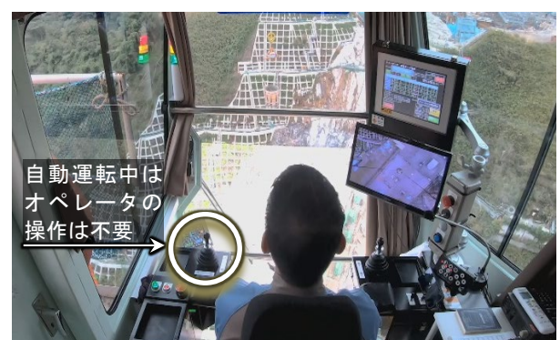
図－6 タワークレーン自動運転状況 (安全監視者のみ搭乗)
