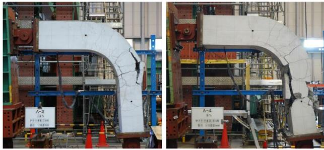
図-6 破壊状況写真
