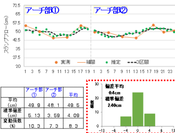
図-15 アーチ施工時のスランプフローの変動状況
