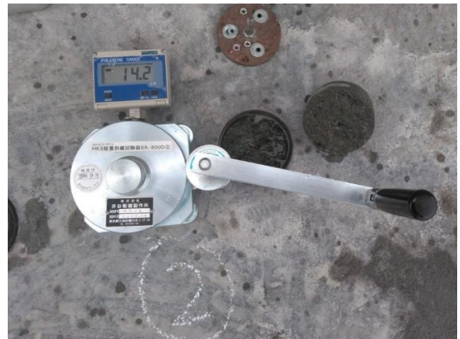
写真-12 建研式付着強度試験状況
